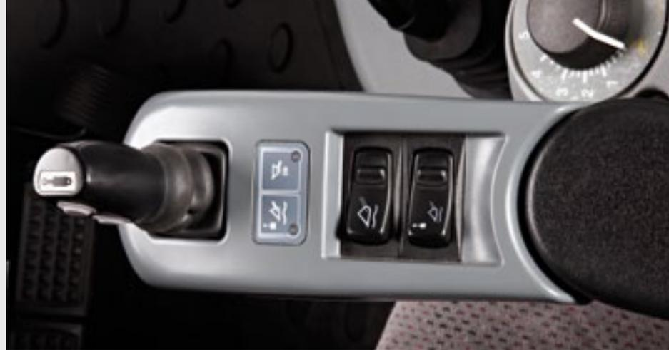
Disponible en option sur les Hi-Tech, vous pouvez piloter votre chargeur à l'aide du joystick présent sur l'accoudoir, ainsi que les 2 DE avant qui sont raccordés aux flexibles hydrauliques du chargeur à l'aide d'un système spécifique Valtra – Quick
