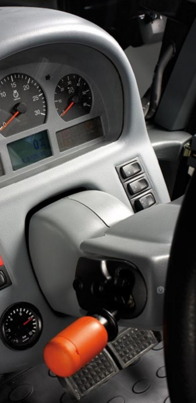
**Les fonctions Auto 1 et Auto 2 sont des fonctions permettant le passage des rapports sous charge automatiquement en fonction d'un régime moteur**
