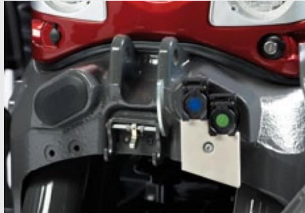
L'hydraulique proposée sur les Versu et Direct offre de très nombreuses possibilités puisque chacun des distributeurs est programmable en temps et en débit depuis l'accoudoir multifonctions ARM. Ces réglages disponibles dans le terminal situés sur l'accoudoir sont très accessibles et rapides à mettre en œuvre.
