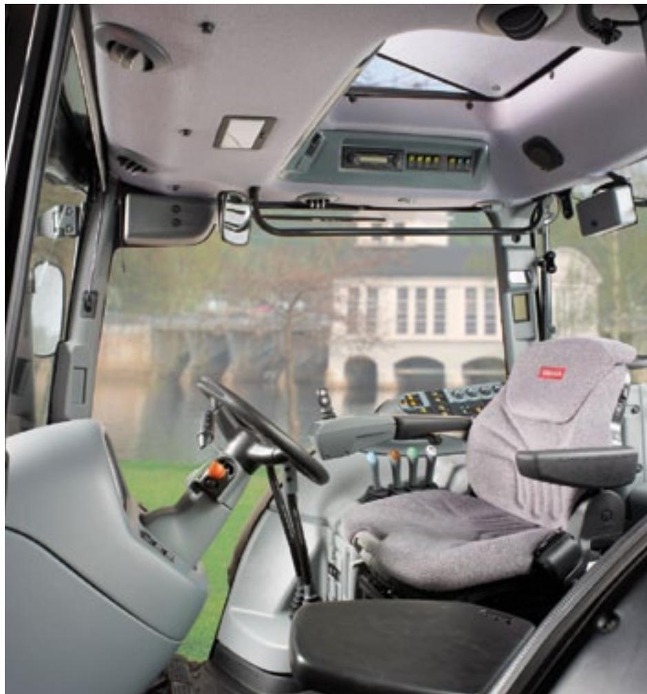
La cabine Municipalité + reprend le principe de base de la cabine Municipalité, à savoir offrir au chauffeur une parfaite visibilité sur la droite tout en respectant sa sécurité. Pour les applications au lamier notamment, la demande de visibilité sur la partie supérieure constitue une grosse demande. Avec son toit vitré panoramique, la visibilité sur le travail est optimale.
