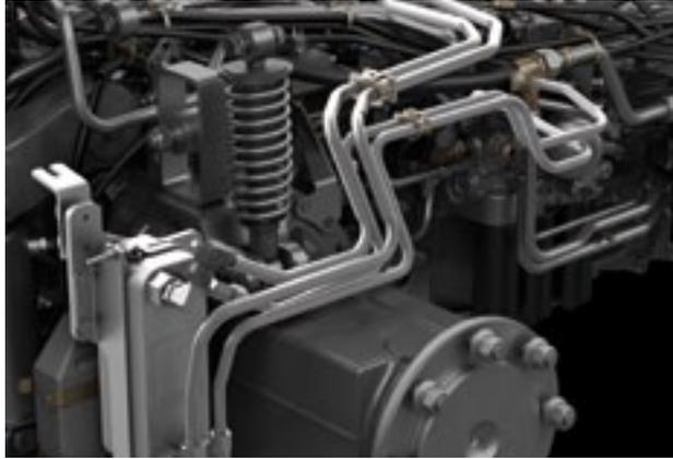
Le circuit hydraulique des Versu & Direct est doté d'une pompe de type Load Sensing. Elle autorise la gestion des distributeurs via des commandes électriques disponible sur l'accoudeur Valtra ARM. Le joystick pilote indifféremment le relevage avant, arrière ou les DE 1 et 2. Dans le
