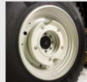
Des masses de roues de 80 kg peuvent être montées de chaque côté afin d'optimiser la stabilité du tracteur mais également de maximiser la productivité à la traction comme au transport.
